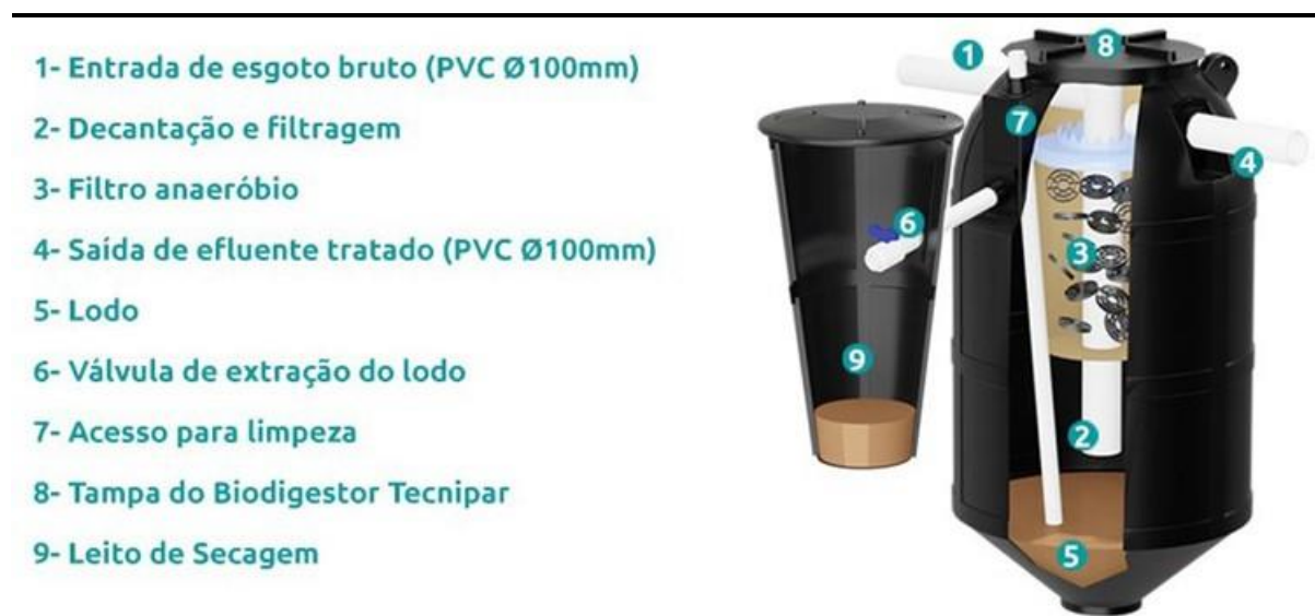
Figura 10 - Biodigestor Compacto Tecnipar
