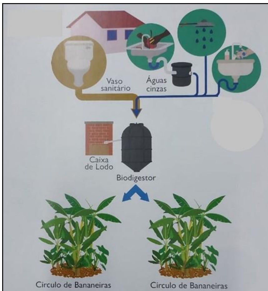
Figura 8 - Esquema do consorcio Círculo de Bananeiras com Biodigestor
